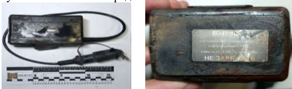
Рисунок 2 – Блок живлення - нерозбірна літієва батарея ВІП-1013 (зразок 2)
