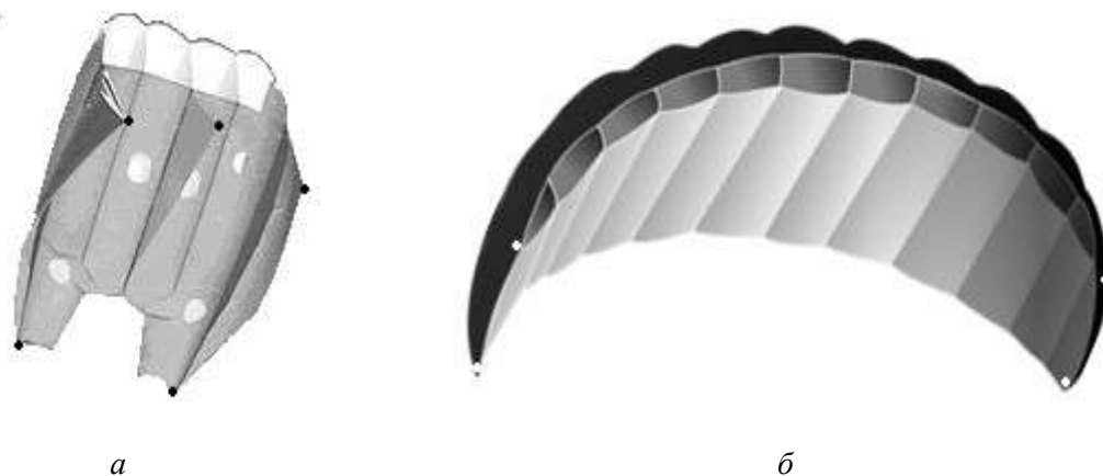
Рис. 2. Кайти – повітряні змії: а – флоуформ; б – парафойл
