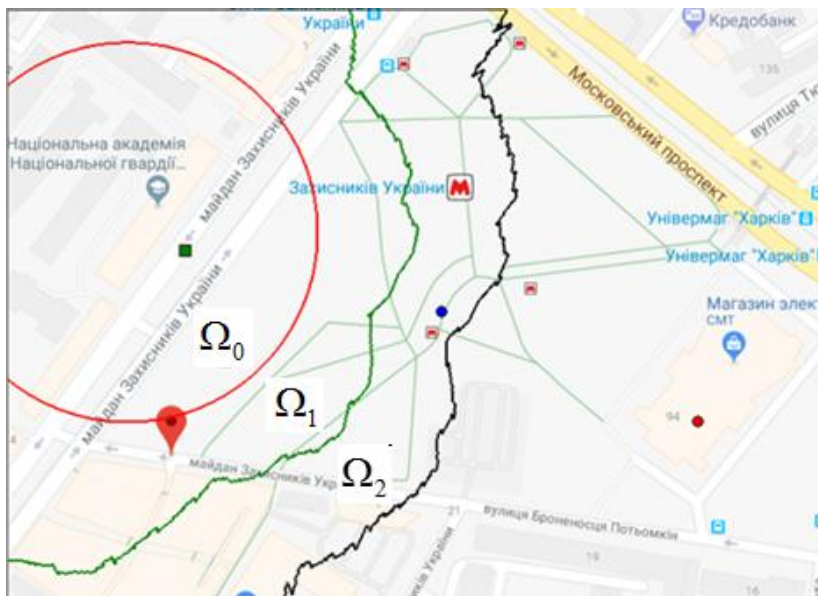
Рисунок 1 – Зони перешкодостійкого радіообміну для різних способів орієнтації спрямованої антени приймача
